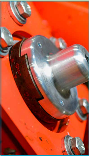
Bezpečné držení pomocí vsazených magnetů
