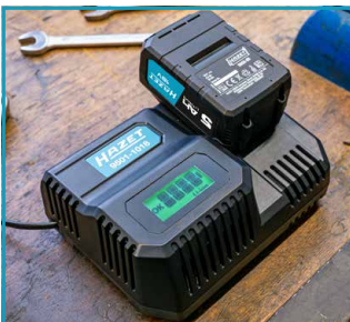
Nabíječka 9501-1018 s „kontrolkou“: Ukazuje stav nabití barevně (červená-žlutá-zelená) a zbývajcí čas až do úplného nabití
