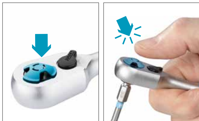
Tlačítko odblokuje bit
